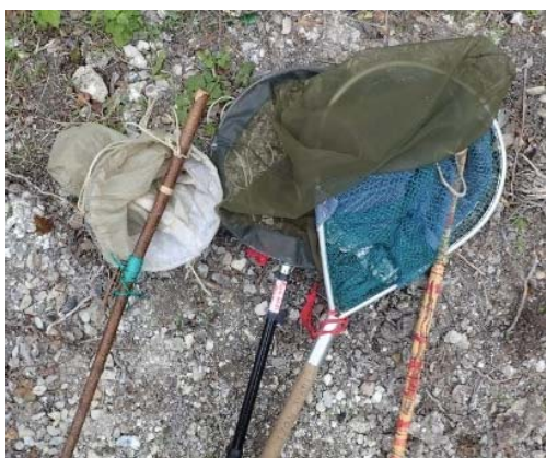
Outils d'échantillonnage, de gauche à droite, filet à plancton, filet à papillons, époussette-troubleau.
